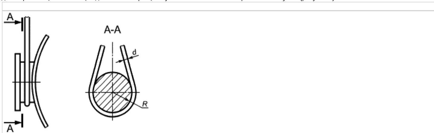
Рисунок 3 - Пример канатной петли без применения коуша
